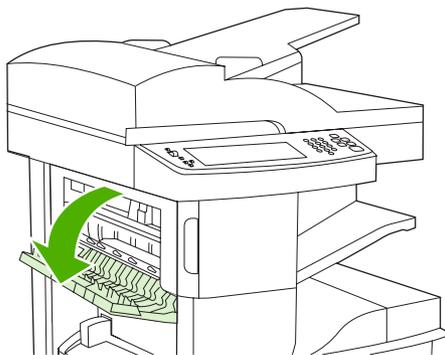
3. Presione la barra verde para soltar cualquier soporte atascado y busque en el interior del dispositivo para ver si hay algún soporte atascado.
