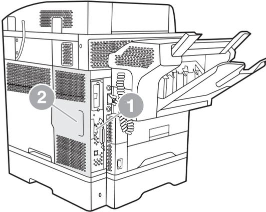
6. Ouvrez la porte du logement du formateur (1) en tirant sur l'ergot de la porte (2) et faites pivoter (3) la porte pour l'ouvrir.
