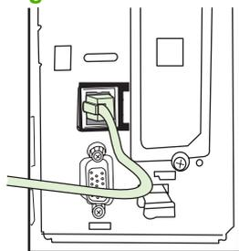
**REMARQUE :** Assurez-vous de connecter la ligne téléphonique au port de l'accessoire télécopieur, situé à proximité de la partie supérieure du formateur. Ne connectez pas la ligne téléphonique au port LAN du périphérique HP Jetdirect, qui est proche de la partie inférieure du formateur.
