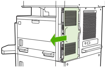
4. Le cas échéant, retirez le capot en plastique de l'accessoire de télécopie du formateur. Insérez une pièce dans la fente située en haut du capot pour vous en servir comme levier afin de retirer le capot du formateur.
