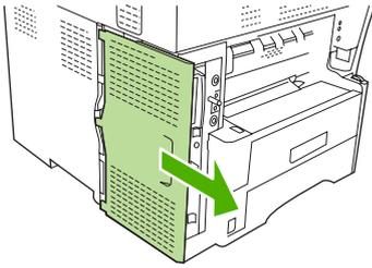
4. Le cas échéant, retirez le capot en plastique de l'accessoire de télécopie du formateur. Insérez une pièce dans la fente située en haut du capot pour vous en servir comme levier afin de retirer le capot du formateur.
