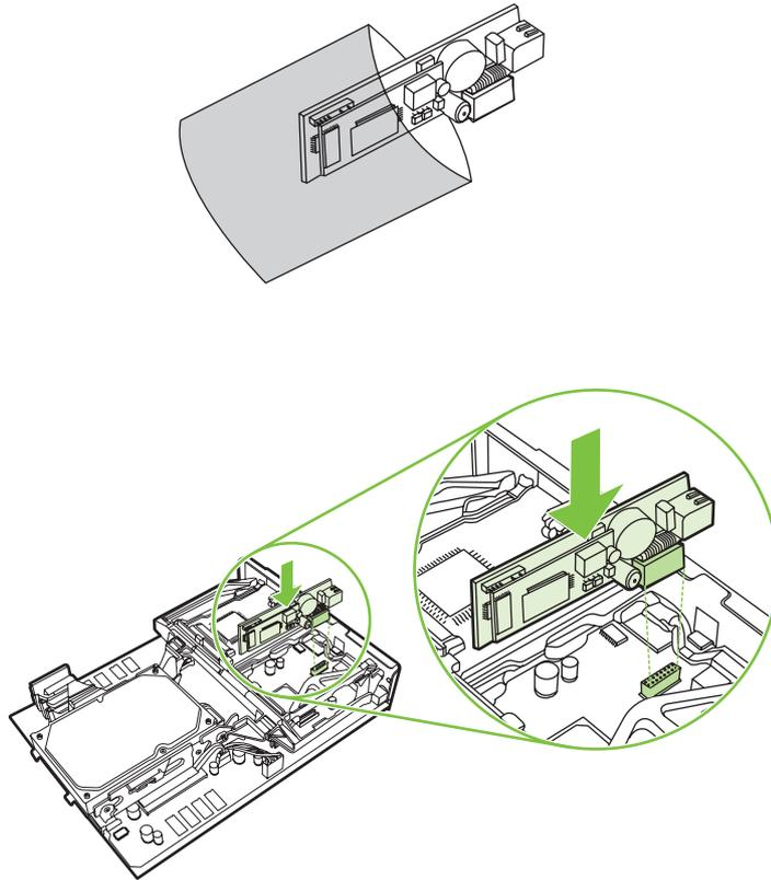
8. Replacez la carte du formateur dans le formateur en la faisant glisser et serrez les deux vis.
