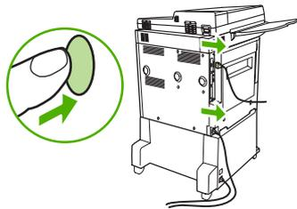
3. Desserrez les deux vis à oreilles du MFP.
