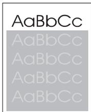
ページの上部に黒色で印刷されるイメージがページの下部に (グレーの範囲内に) 繰り返し印刷される場合、トナーが前回のジョブから完全に消されていない可能性があります (繰り返し印刷されるイメージが、印刷されるフィールドより薄いまた濃い場合があります)。
