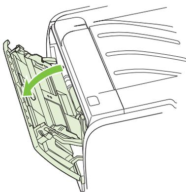
Les guides papier permettent de maintenir les feuilles alignées de façon qu'elles s'insèrent correctement dans l'imprimante afin d'éviter les impressions de travers. Lors du chargement du support, veillez à régler les guides papier sur la largeur et la longueur du support utilisé.
